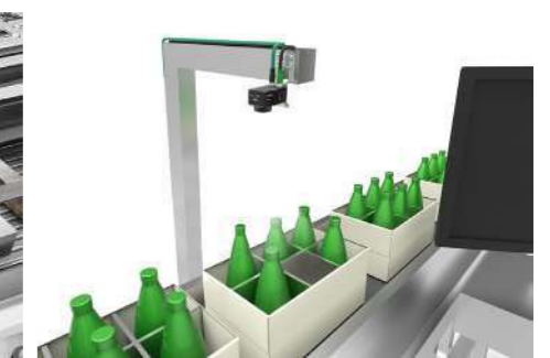
Medición de altura después de la unión
